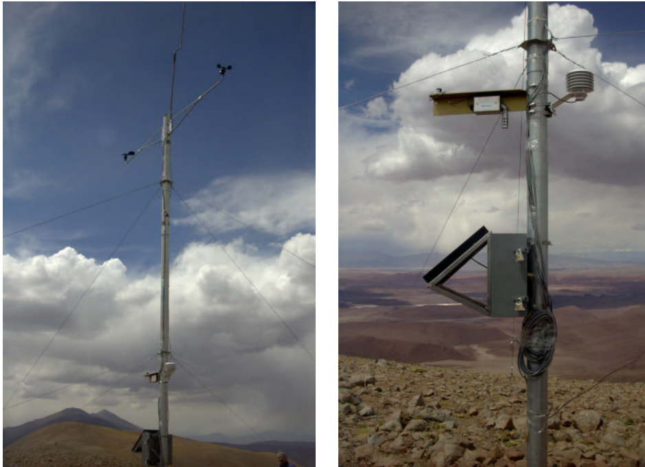
Figura 2. La Estación meteorológica NRG systems, sensores, torre y panel solar.
